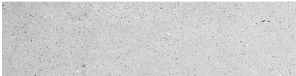
Maschinelles Schleifen; C60 entspricht einem Grobschliff, C120 einem Mittelschliff und C220 einem Feinschliff. Bildmassstab 1:1
