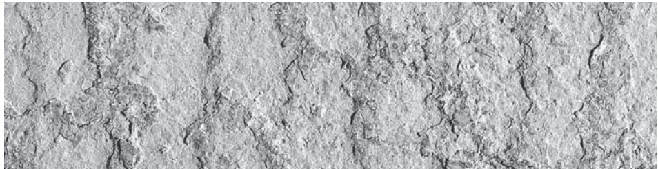
Maschinell mit einer Schweissflamme erzeugt. Bildmassstab 1:1
