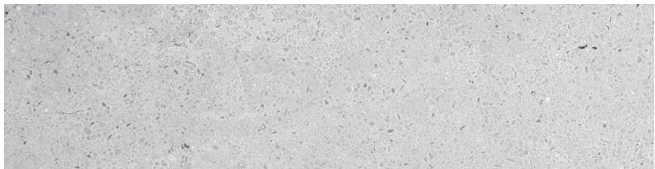
In der Regel maschinell, durch Schleifen und Polieren, auf Glanz bearbeitete Steinoberfläche. Bildmassstab 1:1
