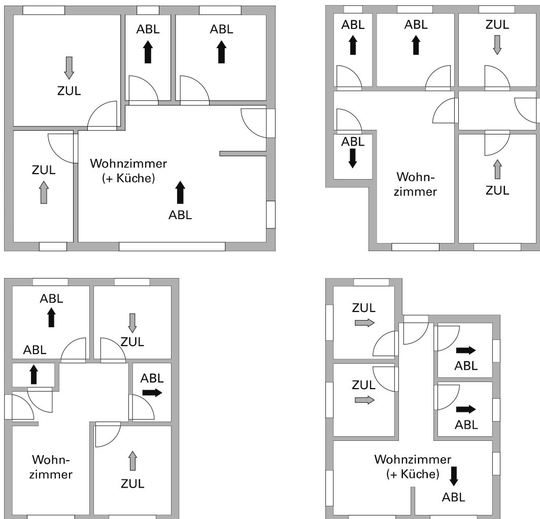
Figur 15 Grundrissbeispiele zu Kaskadenlüftung
